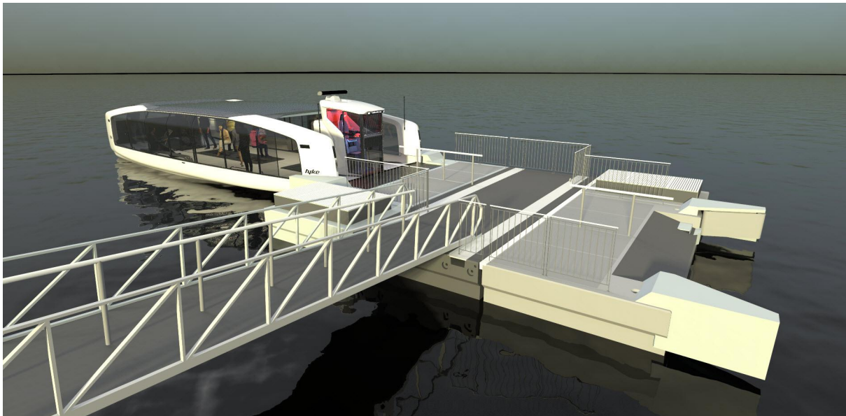
Le ponton a un système de recharge et d'amarrage automatique, l'embarquement des passagers se fera par la proue du bateau © Hyke-Rivercat
